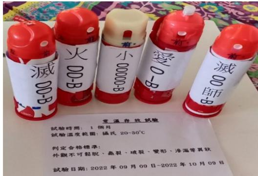
圖 4 A-2~E-2 滅火器於長期室溫 20°C~30°C 之恆溫試驗圖
