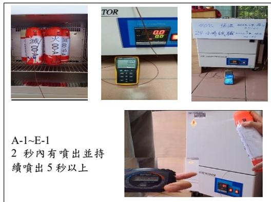
圖 1 A-1~E-1 滅火器在試驗條件 0°C，24 小時以上之恆溫試驗圖
