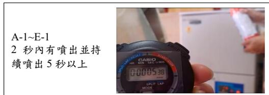
圖 2 A-1~E-1 滅火器在試驗條件 40°C，24 小時以上之恆溫試驗圖
