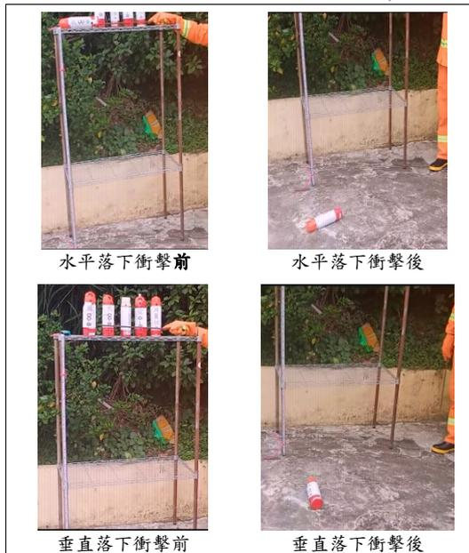
圖 5 A-2~E-2 滅火器進行水平與垂直衝擊試驗圖
